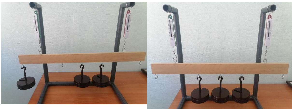
Рис. 4. Варианты нагружения балки одинаковыми по значениям силами, приложенными в разные точки
