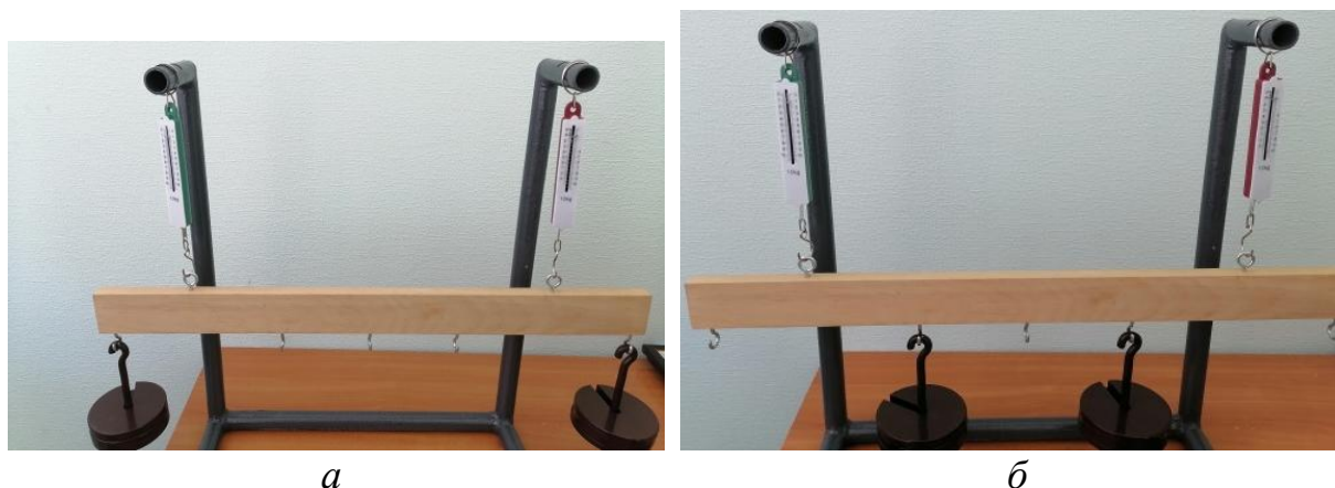
Рис. 6. Варианты разных схем нагружения с равными реакциями: a – нагружение балки двумя силами P , приложенными на концах консолей; б – нагружение балки двумя силами P , приложенными в пролете
