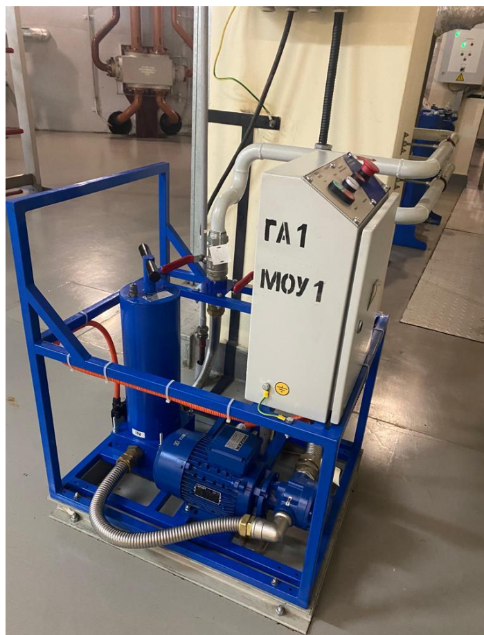
Рис. 1. Передвижная маслоочистительная установка
