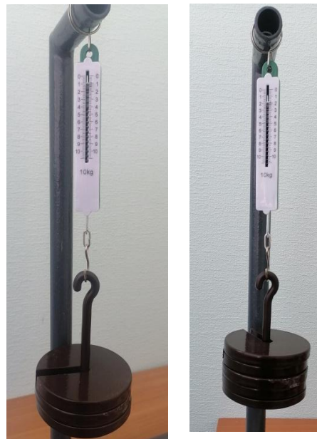
Рис. 2. Изменение показателей безмена при изменении нагрузки
